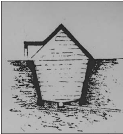
Obr. 9. Konštrukčný princíp ľadovne so zužujúcim sa priestorom nadol. V úrovni podlahy zachytený prierez kanálom s napojeným trativodom. Repróto ML Preiss, Deutsche Stiftung Denkmalschutz, Bonn. Dostupné na internete : https://www.monumente-online.de/de/ausgaben/2014/5/ewiges-eis.php dňa 8.8.2021.
