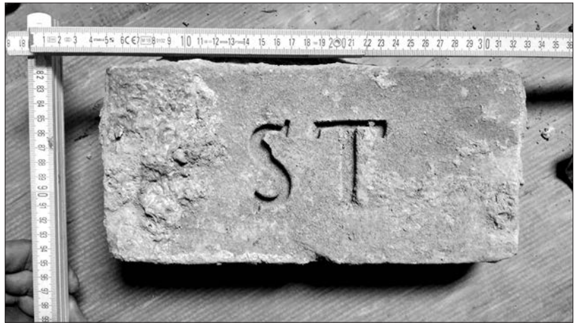
Obr. 10. Príklad tehly primárne použitej v murive ľadovne.
