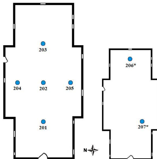
Obr. 6.8. Pôdorys artikulárneho evanjelického kostola v Leštinách s vyznačením miest meraní relatívnej vzdušnej vlhkosti v interiéri.
