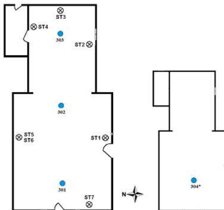
Obr. 8.6. Pôdorys rímsko-katolíckeho kostola Všetkých svätých s vyznačením miest meraní v interiéri: ⊗miesto merania vlhkosti drevej hmoty, ●mieo merania vzdušnej vlhkosti.
