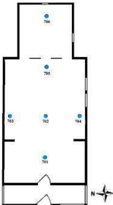
Obr. 1.5. Pôdorys grécko-katolíckeho chrámu sv. Mikuláša v obci Bodružal s vyznačením miest meraní relatívnej vzdušnej vlhkosti v interiéri.
