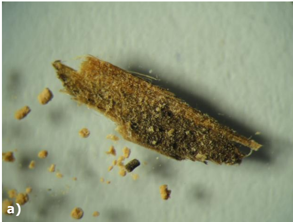
Obr. 56 a – b) Fotograficky zdokumentované požerky pomocou optickej mikroskopie.
