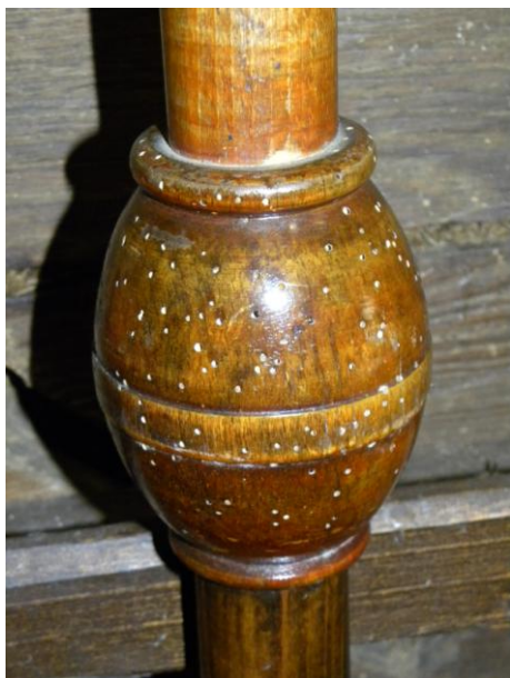
Obr. 85 Rozsiahly výskyt otvorov po drevokaznom hmyze na procesiovom kríži.
