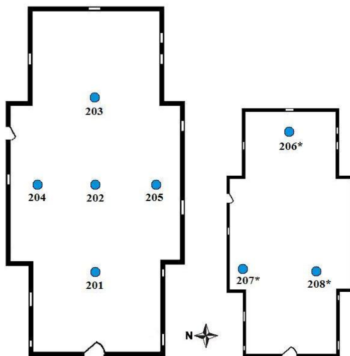
Obr. 74 Pôdorys artikulárneho evanjelického kostola v Leštinách s vyznačením miest meraní relatívnej vzdušnej vlhkosti v interiéri.
