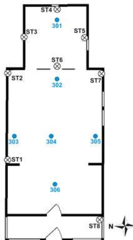
Obr. 1.6. Pôdorys grécko-katolíckeho chrámu sv. Mikuláša v obci Bodružal s vyznačenými miestami jednotlivých meraní. ⊗ miesto merania vlhkosti drevnej hmoty ● miesto merania vzdušnej vlhkosti
