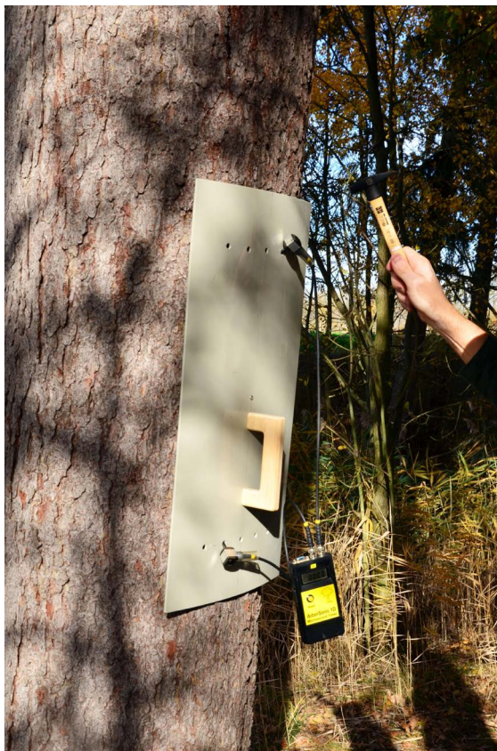
► Obr. 11. Meranie točivosti pomocou šablóny.
