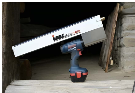
► Obr. 6. Rezistograf na meranie mechanického odporu materiálu.
