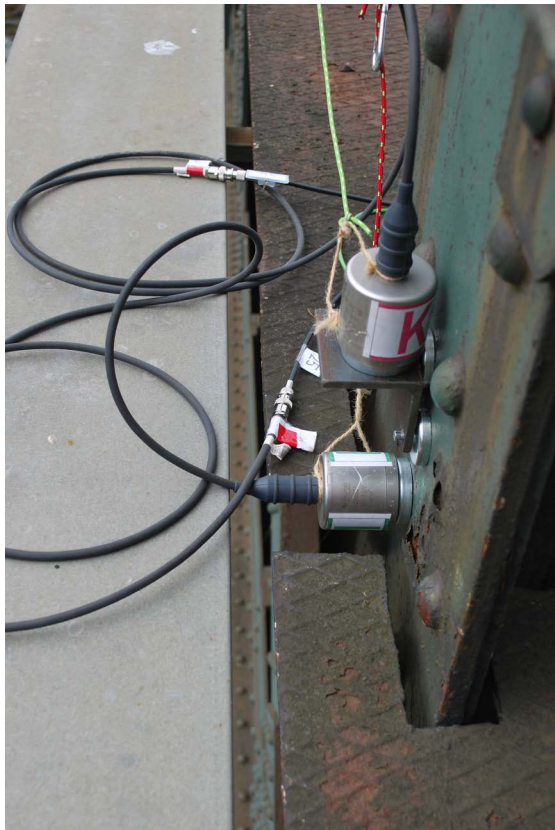
► Obr. 4. Dynamické meranie konštrukcie, Strečno.
