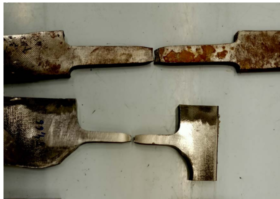
► Obr. 39. Materiálová skúška ocele – ťah, Bratislava.
