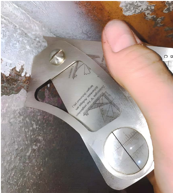
► Obr. 25. Meranie výšky zvaru, Bratislava.
