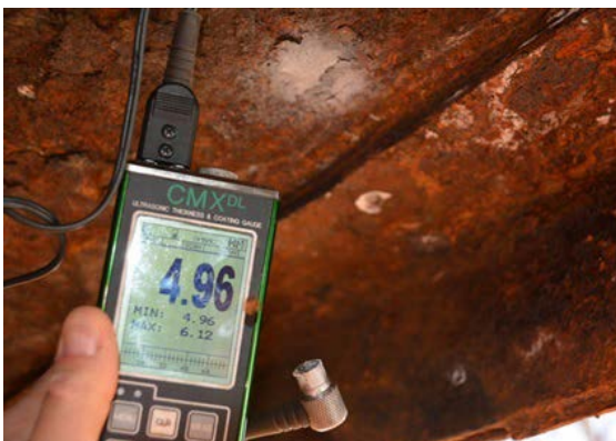
► Obr. 16. Meranie hrúbky ultrazvukom, Poprad.
