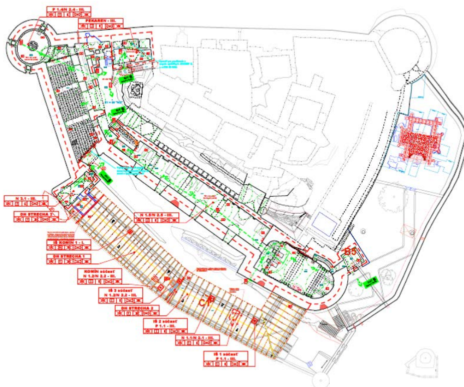
► Obr. 12. Požiadavky na vybavenie stavby Krásna Hôrka požiarnotechnickými zariadeniami.
